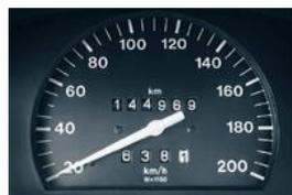
Le compteur kilométrique mesure de longues distances. Il est gradué en **km** et **centaines de m**.
