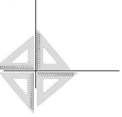
On place l'angle droit de l'équerre dans l'angle que l'on veut vérifier. Ii les deux droites sont perpendiculaires, les deux bords de l'équerre coïncident exactement avec les deux droites. On peut placer l'équerre de différentes manières.
